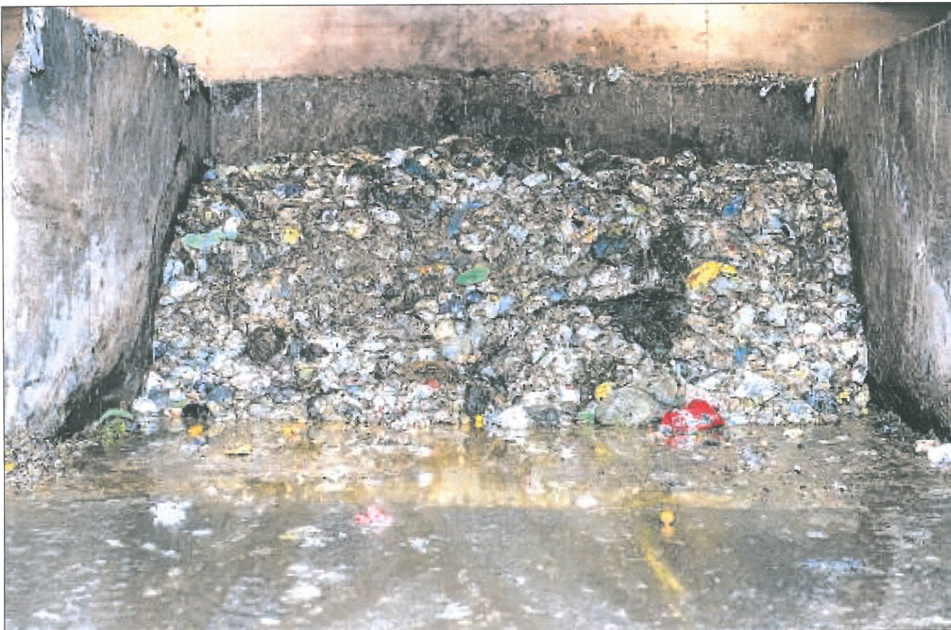
Her er det madaffald, der kommer fra en halv snes sjællandske kommuner, der skal behandles i biogas- og komposteringsanlægget hos BioVækst i Audebo. Der er også gennemført forsøg med fast biomasse fra økologiske landmænd, og her har græs-ensilage vist det største potentiale. Foto: Mie Neel
